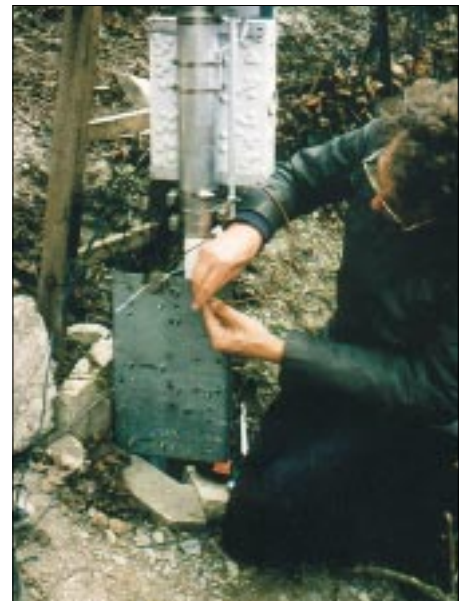
Bild 2: DK8ND am Mastfuß beim Abgleich; vor der umgebauten Boomhalterung aus Zinkblech erkennt man die Koppelspule für das Dipmeter. Die Isolatoren für die Haarnadelschleife bestehen aus PVC-Rohr.
