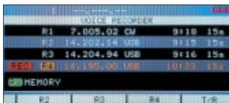
Bild 18: Sein Pendant, der Empfangs-Voice-Recorder nimmt max. 4 x 15 s beliebiges Empfangssignal, ggf. mit bis zu 30 min „Vorstart“, auf. Speicher 4 ist noch durch eine separate Taste, s. Bild 15, steuerbar. Das blinkende REC, oben rechts im Bild, signalisiert, daß der Recorder (in seinem 30-min-Limit) arbeitet.
