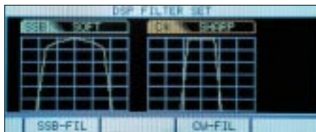
Bild 16: Um das Menü für die Umschaltung der neuen SSB- und CW-Soffilter zu erreichen, braucht es drei Tastendrucke.
