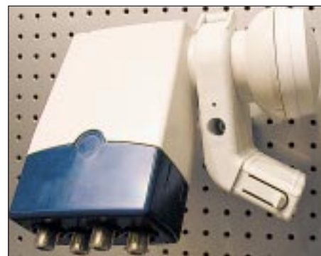
Bild 2: Ein Quad-LNB liefert an seinen vier Ausgängen je zweimal H/V im analogen bzw. digitalen Frequenzbereich. Fotos: DL2RD
