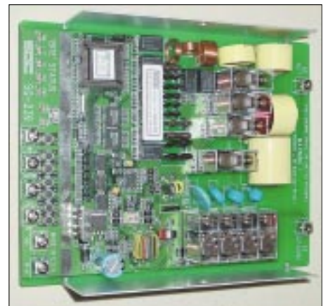
Bild 2: Blick auf die Platinenoberseite mit den HF- und Steuerungsbauteilen Fotos: DK7ZB
