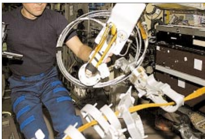
Die noch zusammengerollte Kurzwellenantenne WA4 vor der Montage an der ISS
