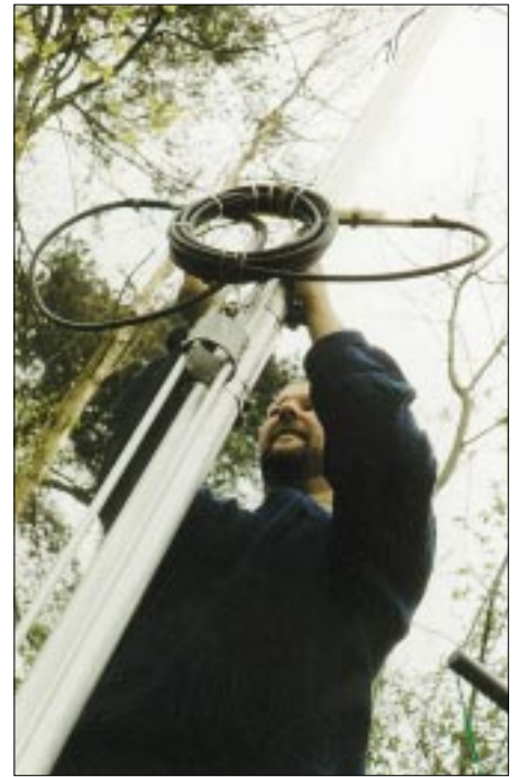
Bild 7: Verlängerungsspule aus Koaxialkabel; zum genaueren Abgleich der Mittenfrequenz ist eine Windung teilweise herausgezogen. Fotos: DK8ND
