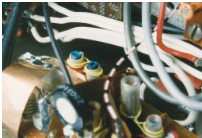
Bild 2: Zwei in einem realen Schaltungsaufbau untergebrachte Zweikreisfilter, jeweils mit aus gelben Drähten hergestellter Link-Kopplung
