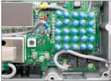
Bild 11: Diese „Bonbonschachtel“ wurde als Sub-Leiterplatte für die mit größeren Spulen aufgebauten Empfänger-Eingangsfiler 1 bis 5 für 1,6 bis 8 MHz notwendig.
