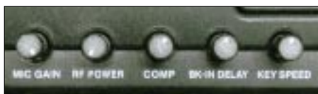
Bild 14: Der häufig zu bedienende Steller für das CW-Tempo wanderte nach rechts außen, um besser erreichbar zu sein.
